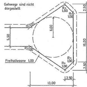
Bild 32: Wendehammer für Lastkraftwagen bis 10,00 m Länge (3-achsiges Müllfahrzeug, Lkw 22,0 t) mit Wendekreis für Personenkraftwagen (Wendeanlagentyp 3)
