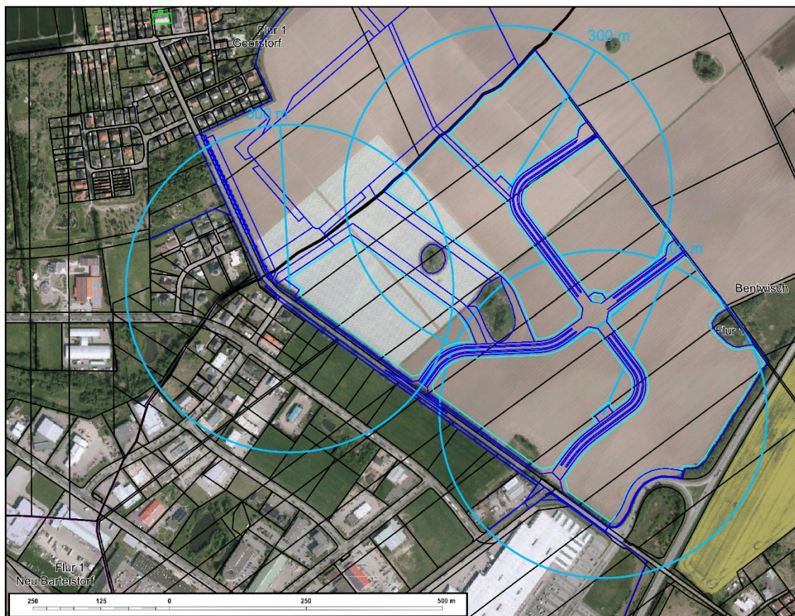
Abb. 10: 300 m Einzugsbereiche um die festgesetzten Löschwasserentnahmestellen
