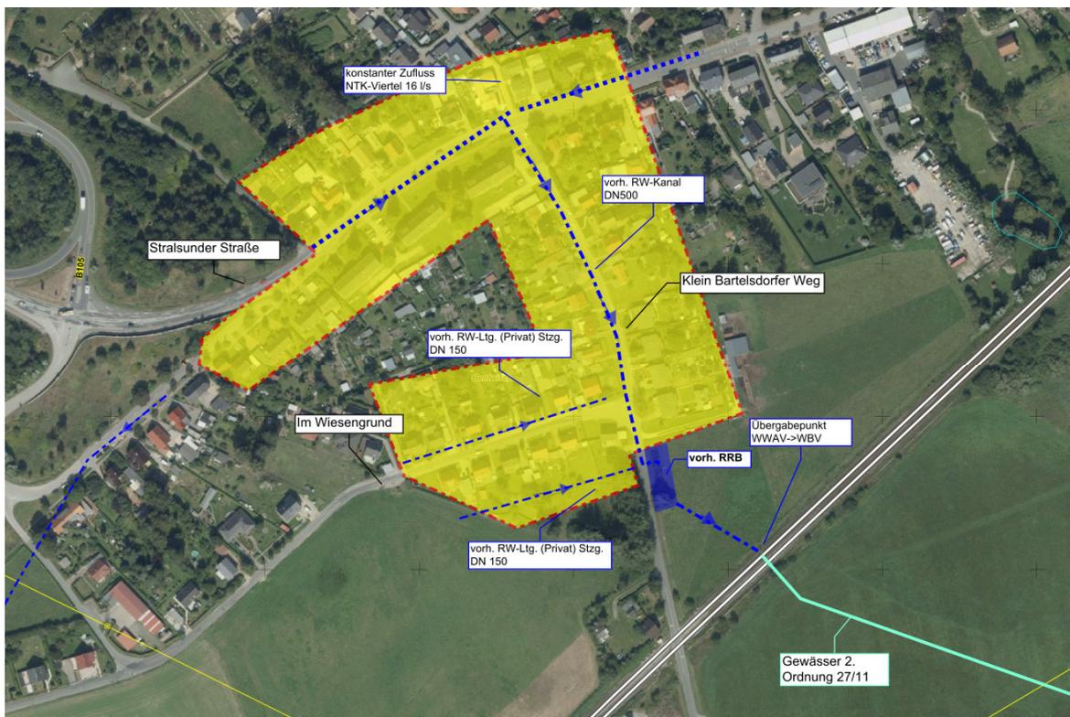
Abb. 3: Einzugsgebiet gemäß Bemessung RW-Kanal Stand 06/2005
